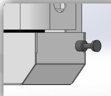
3. Empuje la placa adhesiva en la pista debajo de los tubos
